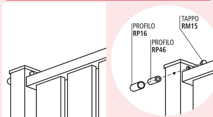
**PARTICOLARE GIUNZIONE PANNELLO PARAPETTO**
