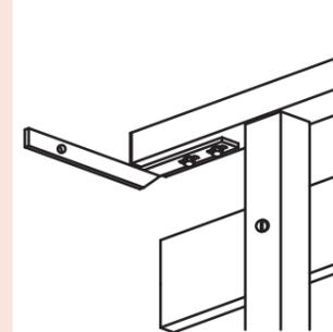
**PARTICOLARE GIUNZIONE PANNELLO PARAPETTO**
